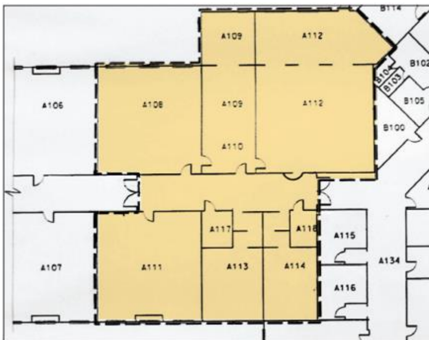
شکل ۱-۰. نمودار منطقه پناهگاه بدون تهویه، که شامل سرویس های بهداشتی و آبخوری ها، در یک مدرسه ابتدایی است
